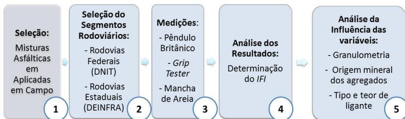
Em cada rodovia selecionada, foram demarcados segmentos de 300m (com SIG) onde foram realizadas 15 medidas de atrito com o Pêndulo e em alguns casos também com o *Grip Tester* e 15 determinações com o ensaio da Mancha de Areia.
