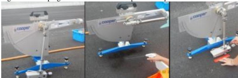
Esse ensaio é considerado dinâmico e de impacto e consiste em mensurar a perda de energia quando a sapata de borracha do Pêndulo desliza sobre a superfície de teste. O equipamento pode ser utilizado tanto em laboratório quanto em campo (em superfícies planas), e os valores mensurados representam o BPN (*British Pendulum Tester Number*) (ASTM – E303-93).
