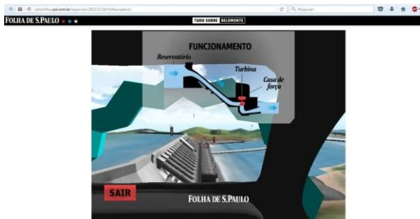
A próxima fase, (figura 24), dá seqüência a temática abordada na etapa anterior. Quando o leitor/jogador sobrevoa essa etapa da obra, as turbinas começam a funcionar, e, é possível ver uma demonstração de como as turbinas usam a força da água para gerar energia.
