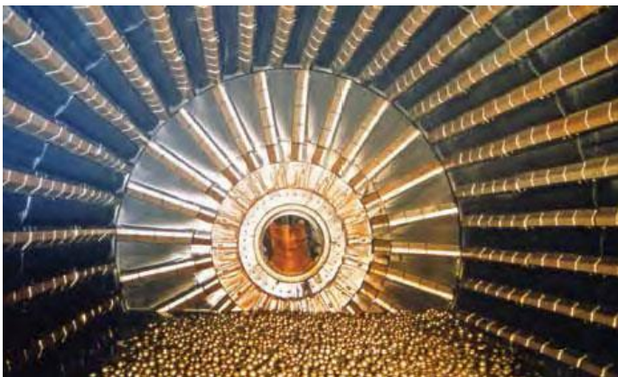
Figura 6 - Parte interna de um moinho de bolas.
