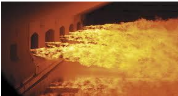
Figura 1: Chamas geradas pela reação de combustão no forno de vidro contínuo regenerativo lateral.
