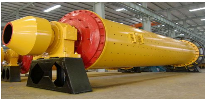
Figura 5: Moinho ou cilindro horizontal rotativo para realização da moagem da bauxita.
