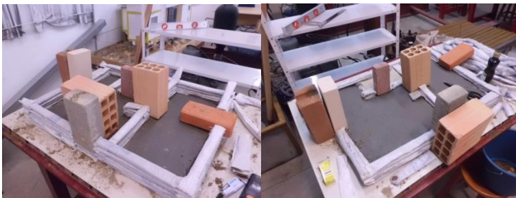
Figura 68 – Modelo em escala reduzida - Tijolos como formas das portas.
