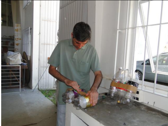
Confecção dos fardos de garrafa PET para teste de flutuação.
