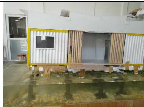
Visualização dos pilares guias sob o container. Estado de flutuação de cerca de cinco centímetros de altura.
