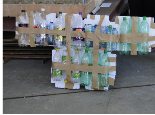
Montagem do fardo, sob camada de EPS de 5 cm.
