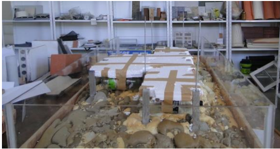
Retirada do modelo das fundações para posicionamento do colchão de flutuação
