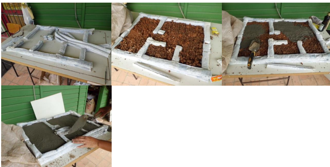
Figura 66– Modelo em escala reduzida - fundação, aterro e contrapiso.
