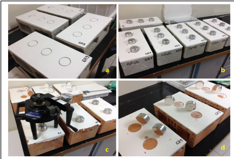
Figura 40 - Ensaio de resistência de aderência à tração – furação, colagem e arrancamento das pastilhas
