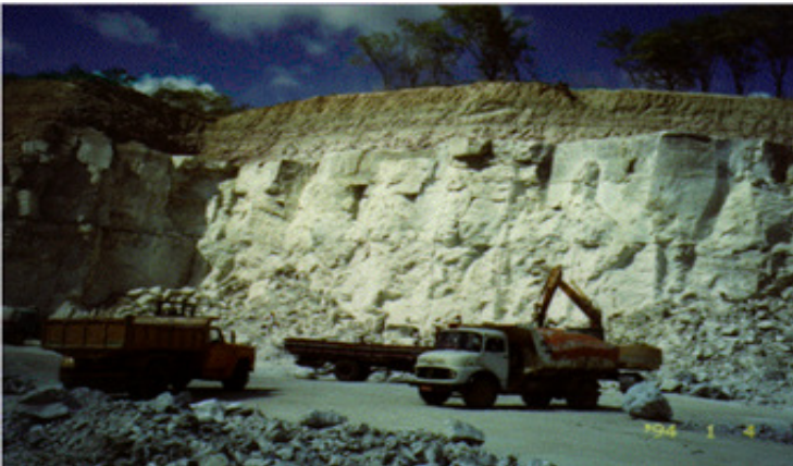
Figura 2 - Frente de lavra de gipsita do Polo Gesseiro de Pernambuco Fonte: C. Baltar, F. Bastos e A. Luz (2004)
