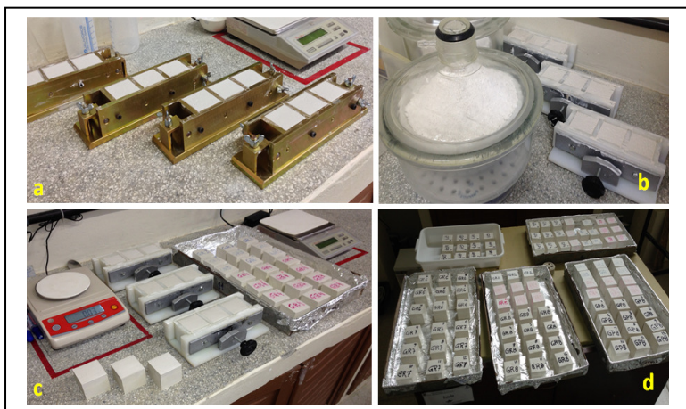
Figura 34 - Moldagem dos corpos de prova para ensaios de resistência à compressão e dureza
