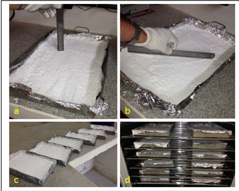
Figura 27 - Preparação das bandejas para calcinação
