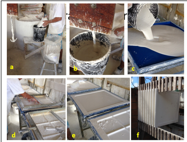
Figura 41 - Produção das placas de gesso reciclado GP8 e GR9
