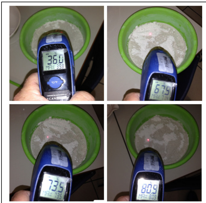
Figura 55 - Medição da temperatura superficial da pasta de gesso no período de descanso. Acervo pessoal
