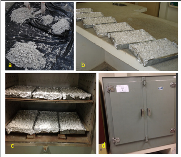
Figura 24 - Secagem dos resíduos de gesso
