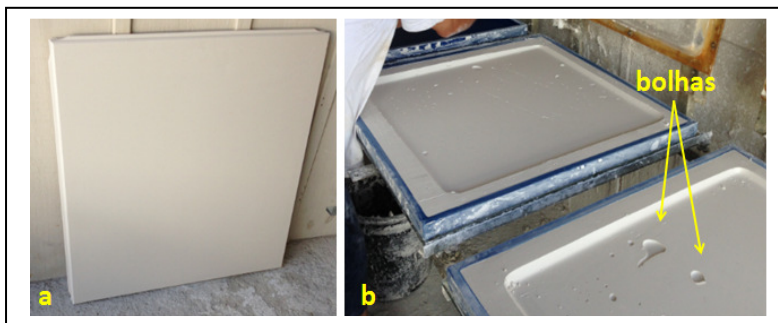
Figura 98 - Placas produzidas com gesso reciclado GP8 e GR9
