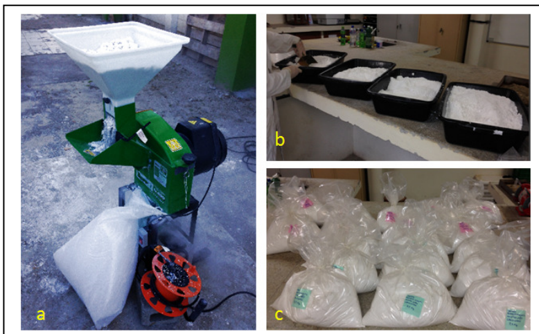
Figura 25 - Moagem, homogeneização e embalagem dos resíduos de gesso
