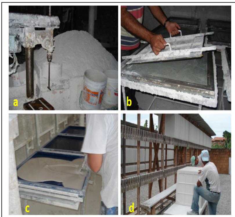
Figura 11 - Argamassadeira de misturar gesso para placas, forma metálica e de silicone Fonte: Fotos (FERNANDES; CÂMARA, 2012)
