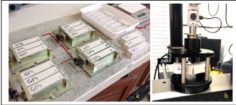
Figura 36 - Moldagem de corpos de prova (a) Rompimento no ensaio de tração na flexão (b).
