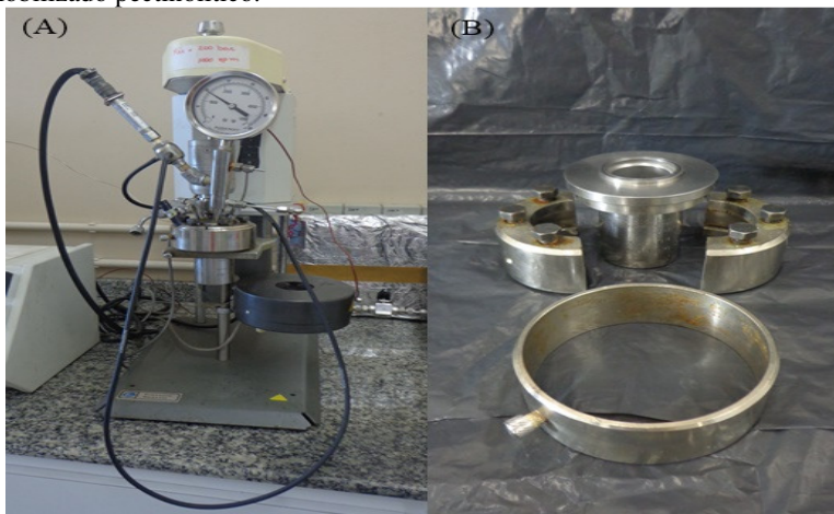
Figura 15 – Detalhes da célula montada e acoplada ao equipamento de alta pressão (a) e em (b) da célula de aço inoxidável com capacidade para 36 g de imobilizado pectinolítico.
