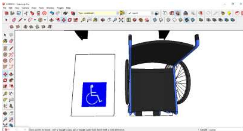
FIGURA 61 – Parametrização e detalhamento digital no Sketchup segundo os parâmetros da NBR 9050:2015 – Sinalização de espaço para P.C.R.
