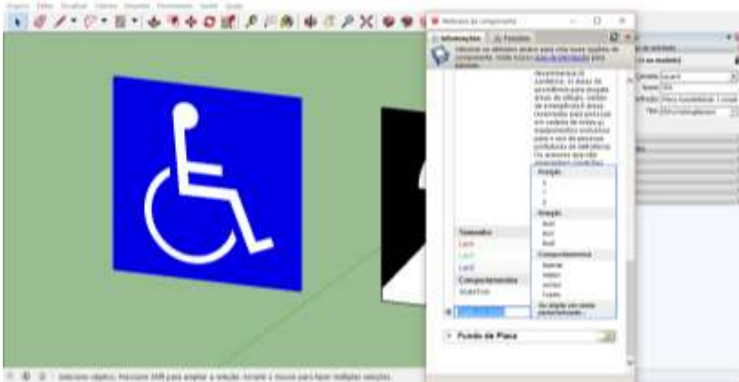
FIGURA 29 – Interface do Sketchup – Atributos de componente.
