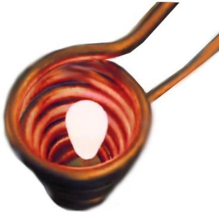
Figura 9 – Bloco de alumínio no centro de uma bobina de indução. As correntes induzidas tornam o bloco incandescente.
