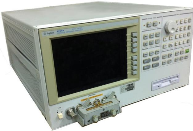
Figura 30 – Analisador de Impedância de Precisão, Agilent, modelo: 4294A, do Instituto de Engenharia Biomédica (IEB-UFSC). Fonte: próprio autor.
