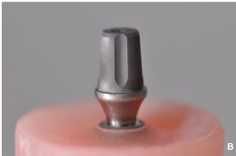
Figura 8 – Jateamento com \text{Al}_2\text{O}_3 modificada por sílica 27\mu\text{m} a 0.2\text{MPa} por 10s a uma distância de 10mm (Coroa e Pilar).
