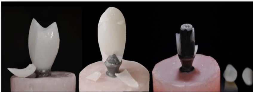
Fig. 3 - Tipos de falhas: a) Falha Coesiva; b) Coesiva e Adesiva (mista); c) Falha Complete Adesiva.
