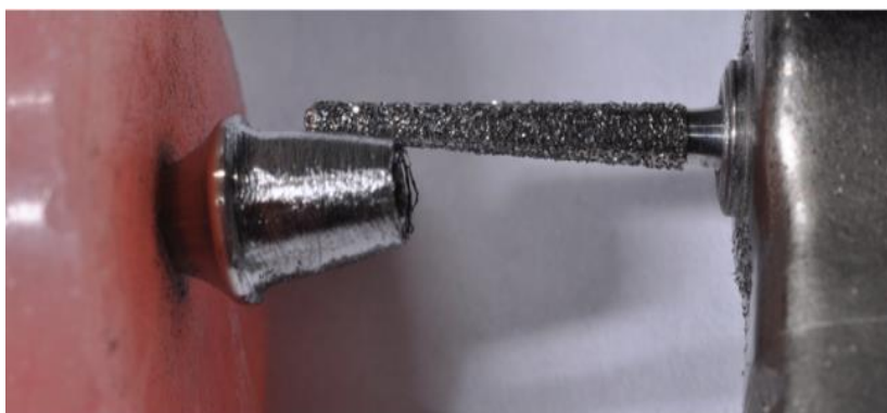
Figura 4 – Preparo dos pilares feito por um único operador calibrado.
