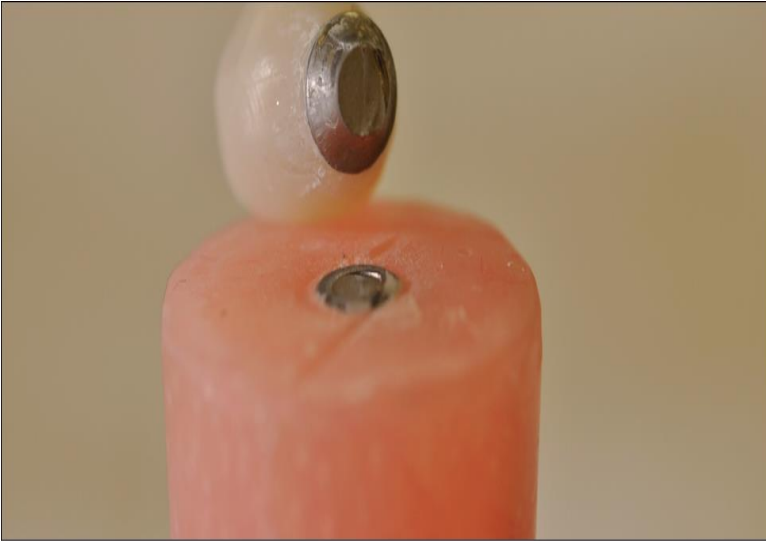
Figura 16 – Pilar fraturado durante testes pilotos com cargas obliquas aplicadas em 30 graus.
