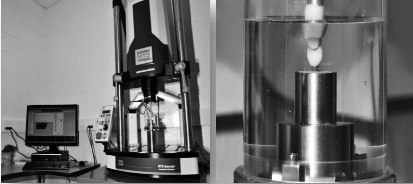
Fig. 2 – a) Sistema de teste utilizado para o carregamento das amostras; b) Câmara de carga preenchida com água destilada, com cargas isométricas aplicadas através de um antagonista cilíndrico de resina composta centralizado no sulco central (dois pontos de contatos).
