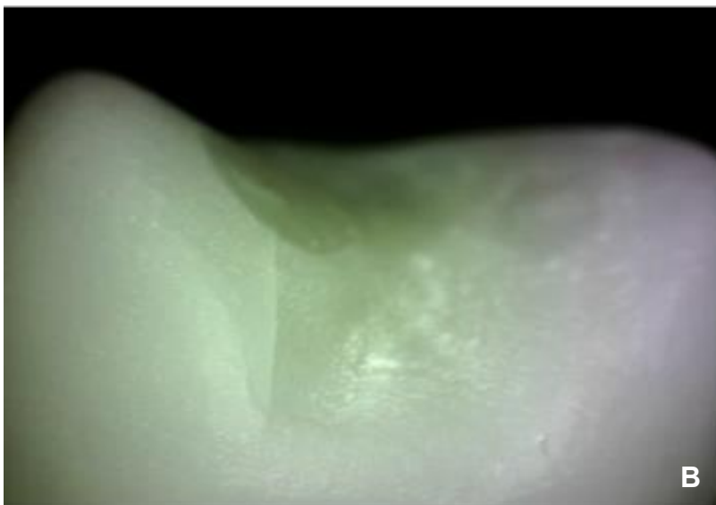
Figura 15 – Facetas de desgastes e trincas observadas em amostras sobreviventes.
