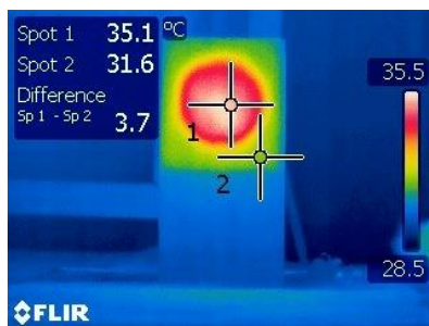
Figura 5.8 – CP4, grupo 1, EPS D=10 cm, aquecido por lâmpada incandescente.
