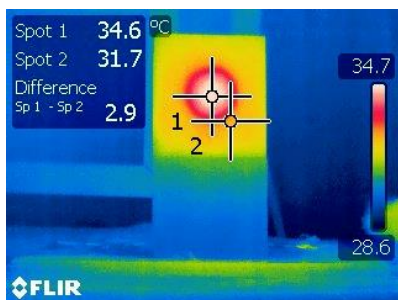
Figura 5.7 – CP3, grupo 1, EPS D=6 cm, aquecido por lâmpada incandescente.
