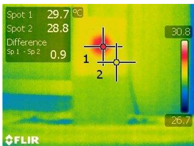
Figura 5.23 – CP3, grupo 1, EPS D = 6 cm, aquecido por lâmpada mista.
