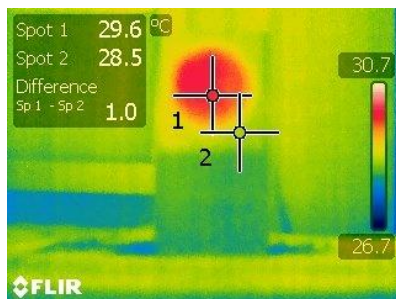
Figura 5.24 – CP4, grupo 1, EPS D = 10 cm, aquecido por lâmpada mista.
