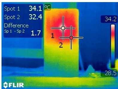
Figura 5.6 – CP2, grupo 1, EPS D=2 cm, aquecido por lâmpada incandescente.
