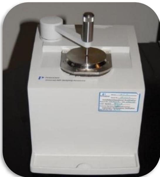
Figura 20: Módulo de ATR do Espectrômetro Spectrum One B, Perkin-Elmer, Inglaterra.
