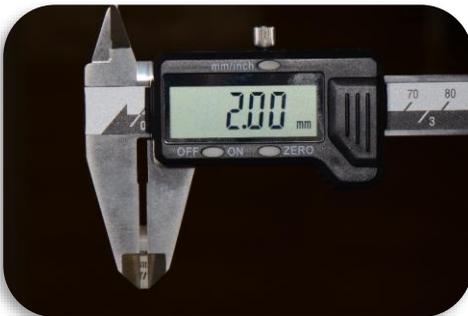
Figura 3: Fatia de Lava Ultimate na espessura de 2mm.
