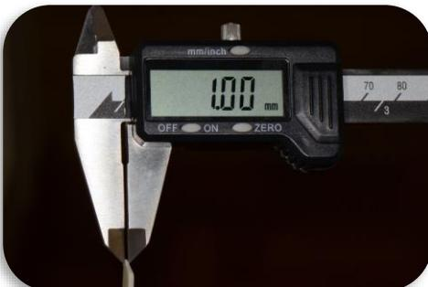
Figura 4: Fatia de Lava Ultimate na espessura de 1mm.
