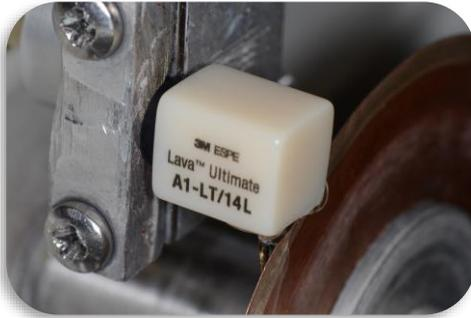
Figura 1: Bloco de Lava Ultimate (3M ESPE) sendo cortado fatiado com o disco diamantado (Isomet 1000).
