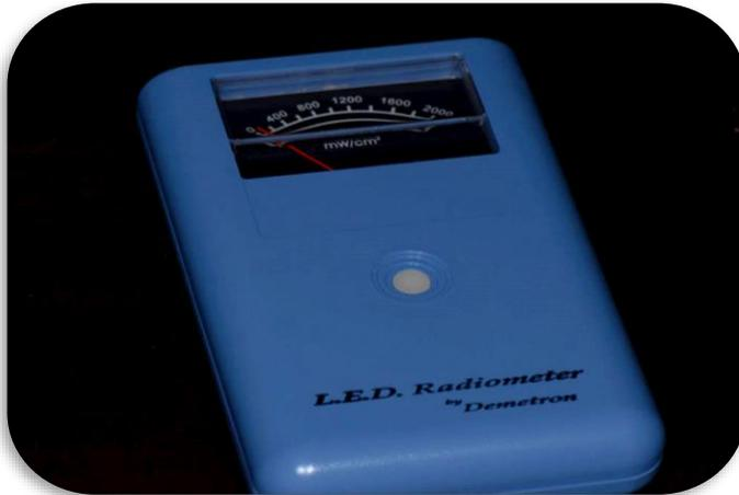
Figura 17: Radiômetro de cura Demetron, Kerr. Utilizado para aferição da potência do fotopolimerizador.
