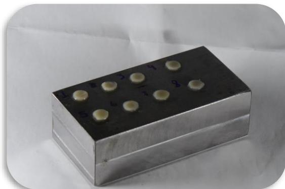
Figura 24: Espécimes colados à base metálica.
