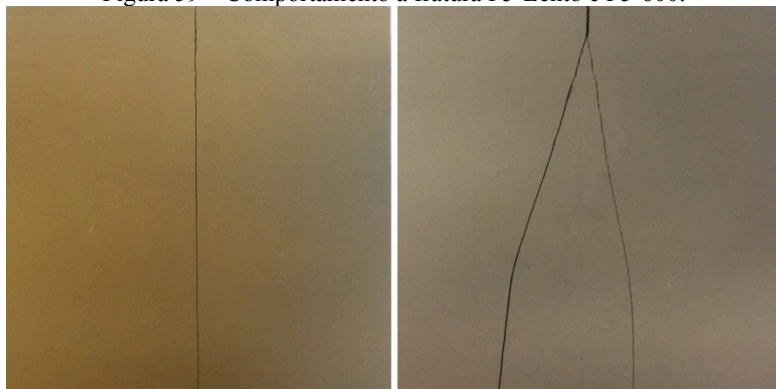
Figura 59 – Comportamento à fratura P5-Lento e P5-600.
