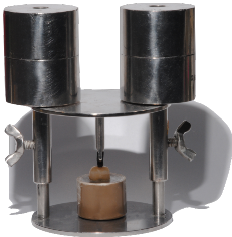
Figura 4 – Dispositivo de Delbons (2010). Aplicando força padronizada para realizar a cimentação.
