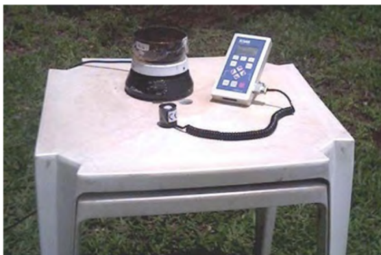
Figura 7. Sistema de foto degradação por irradiação solar.
