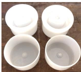
Figura 30 - Moldes de PVC para pastas de cimento
