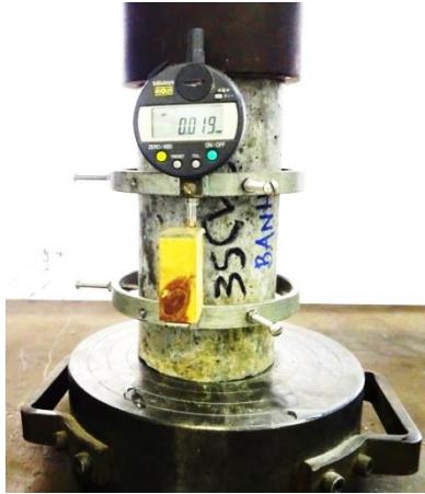
Figura 28 - Ensaio para determinação do módulo estático de elasticidade à compressão dos concretos
