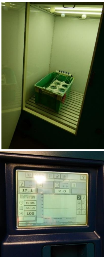
Figura 7: Superior: Detalhe de uma das incubadoras utilizadas na realização do experimento para avaliação do efeito da temperatura no crescimento do ciliado Euplotes sp. Inferior: Detalhe do painel de controle da incubadora, com regulagem da temperatura, umidade e fotoperíodo.
