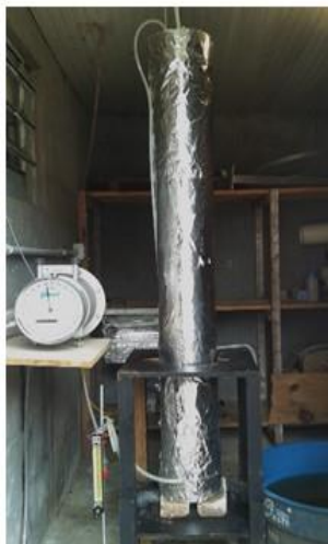
Figura 6- Esquema do biorreator BTF. (1) entrada de biogás; (2) do reservatório de águas residuais; (3) bomba peristáltica; (4) de entrada de águas residuais; (5) saída de águas residuais; (6) saída biogás purificado; (7) termômetro; (8) biorreator.
