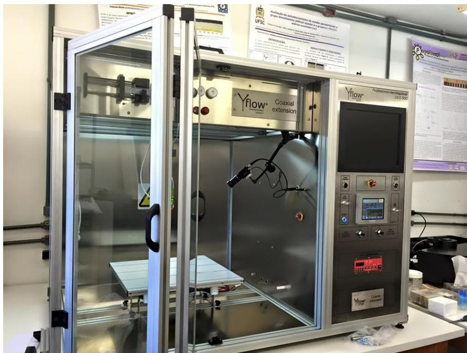
**Figura 9: Foto do equipamento Professional Electrospinner da Yflow utilizado nas eletrofições (Fonte: Prof. Edson Minatti – UFSC).**
