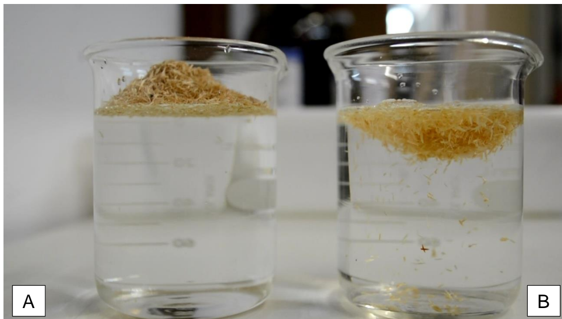
Figura 9 - Serragem em contato com água (A) sem tratamento e (B) tratada por plasma frio.
