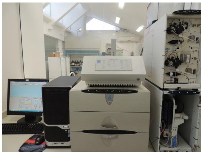
Figura 4. Cromatógrafo de troca iônica utilizado para as determinações dos ânions.
