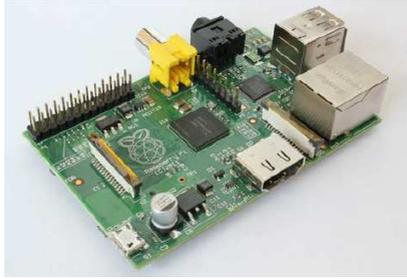
Figura 19 – Raspberry Pi modelo B
