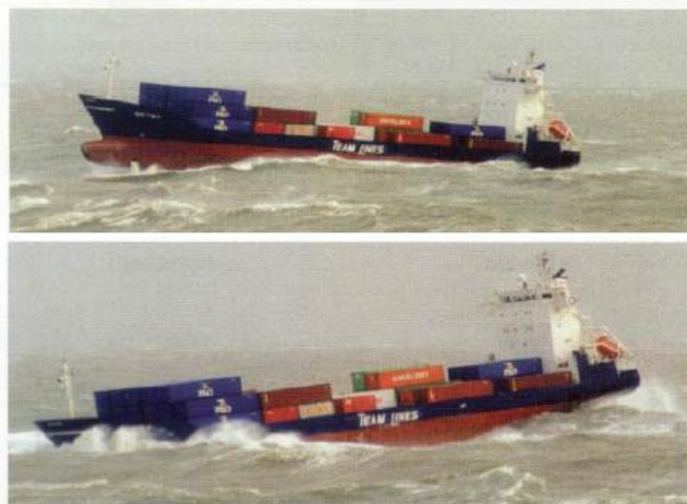
Figura 9 - Carregamento devido à ondas de Alquebramento e Tosamento
