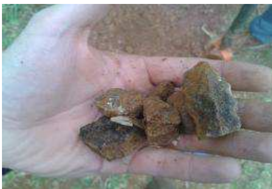
Figura 63 – Presença de rocha fragmentada na sondagem SP-01 na profundidade de 2,45 metros
