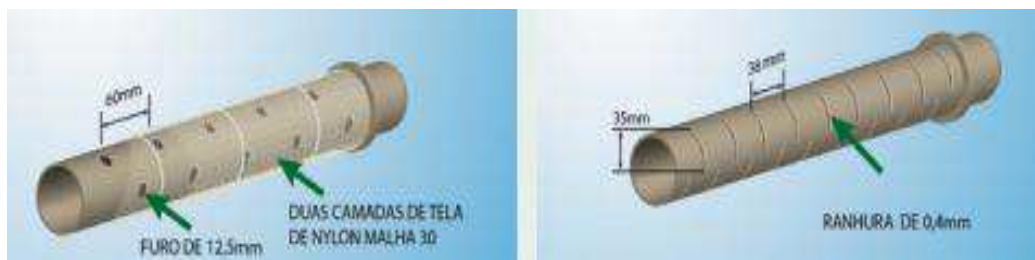
Figura 28 - Exemplo de dreno profundo (DHP)
