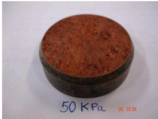
Figura 59 – Amostra de solo moldada em anel no laboratório da UFRGS para realização de ensaio de cisalhamento direto
