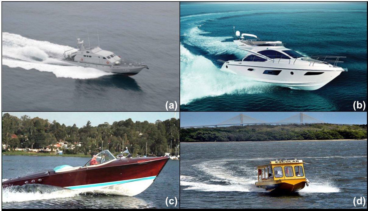
Figura 3 – (a) Embarcação militar de alta velocidade construída em aço; (b) Lancha de passeio construída em material compósito; (c) Lancha de passeio construída em madeira; (d) Lancha construída em alumínio para transporte de pessoas.
