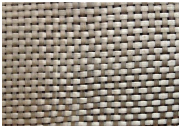
Figura 13 – Detalhe da malha do tecido de fibra de vidro utilizado na confecção das amostras.
