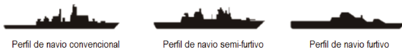
Figura 8 – Evolução da geometria de embarcações, visando a redução da RCS
