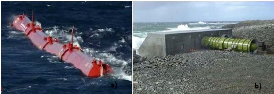
Figura 4 - Dispositivos conversores de energia das ondas: a) Pelamis, b) Dispositivo de coluna de água oscilante. (Fonte: GODINHO, 2010)
