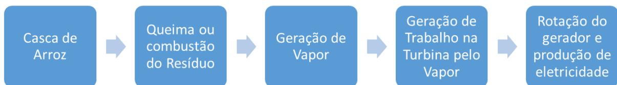
Figura 6 – Processo de Conversão em Energia Elétrica através da Casca de Arroz. (Fonte: Autor, 2016).
