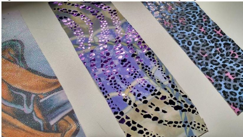
Figura 13: Testes de aplicação de foil em tecido com estampa digital.
