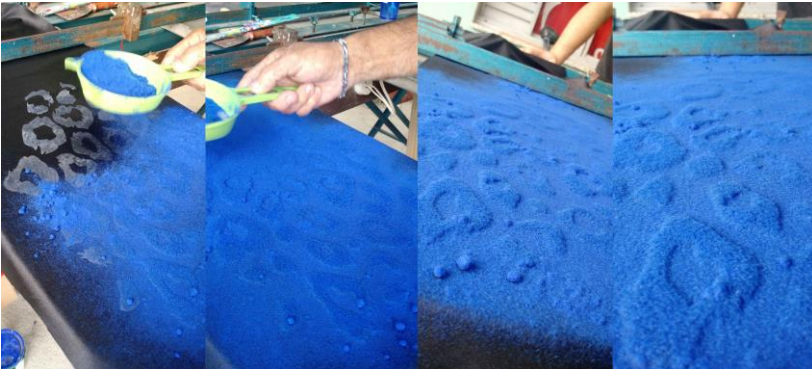
Figura 54: Aplicação do flocado
