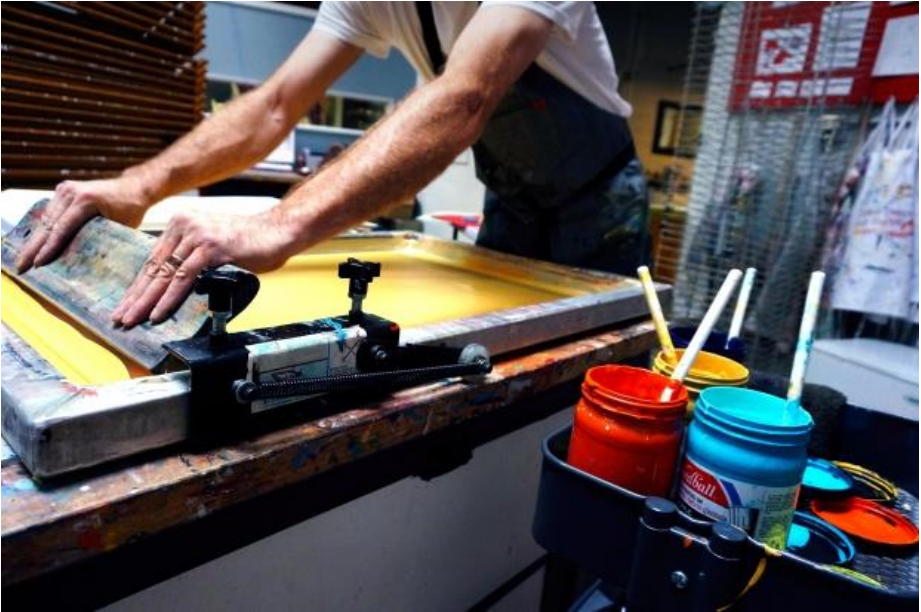
Figura 8: Quadro e rodo utilizados no método de estamparia manual
