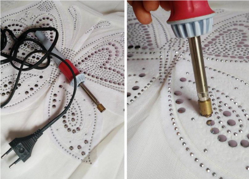
Figura 17: Caneta térmica para fixação pontual de hotfix .
