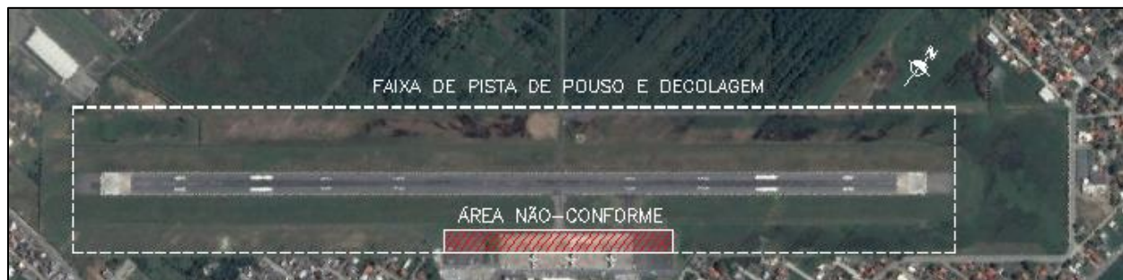
Figura 13 - Faixa de pista de pouso e decolagem e área não-conforme
