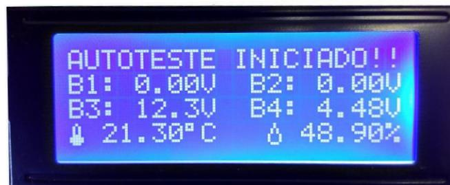
Figura 31 – Tensões das baterias durante procedimento de Autoteste (Fonte: do autor).
