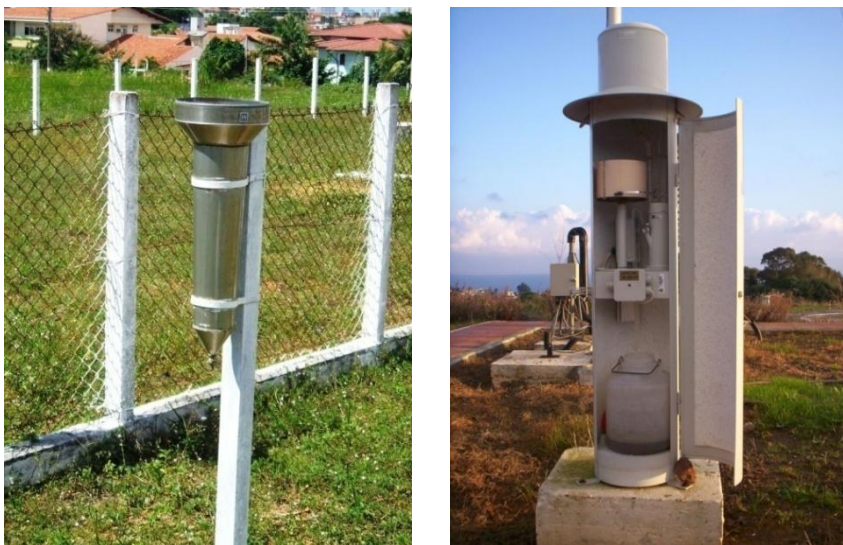
Figura 3– Pluviômetro (Esquerda) e Pluviógrafo (Direita).
