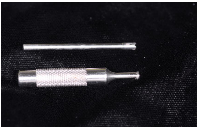
Fig. 12: Chaves para remoção e instalação da nova cápsula.
