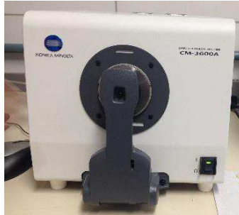
Figura 7 – Espectrofotômetro de esfera de integração (Minolta CM 3600d, Konica Minolta, Japão).
