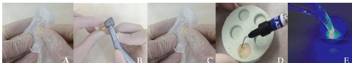
Figura 5 – Sequência da confecção das amostras do Grupo 3. Em (A e C) limpeza da superfície com álcool 70°; (B) Asperização da superfície; (D) Reparo com Resina Flow ; (E) Fotopolimerização do reparo.
