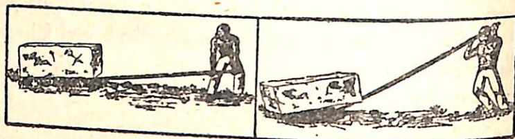
Exemplo de alavanca inter-resistente
