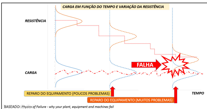
Figura 15: Atuação da falha (baseado em LRS Plant 2012).
