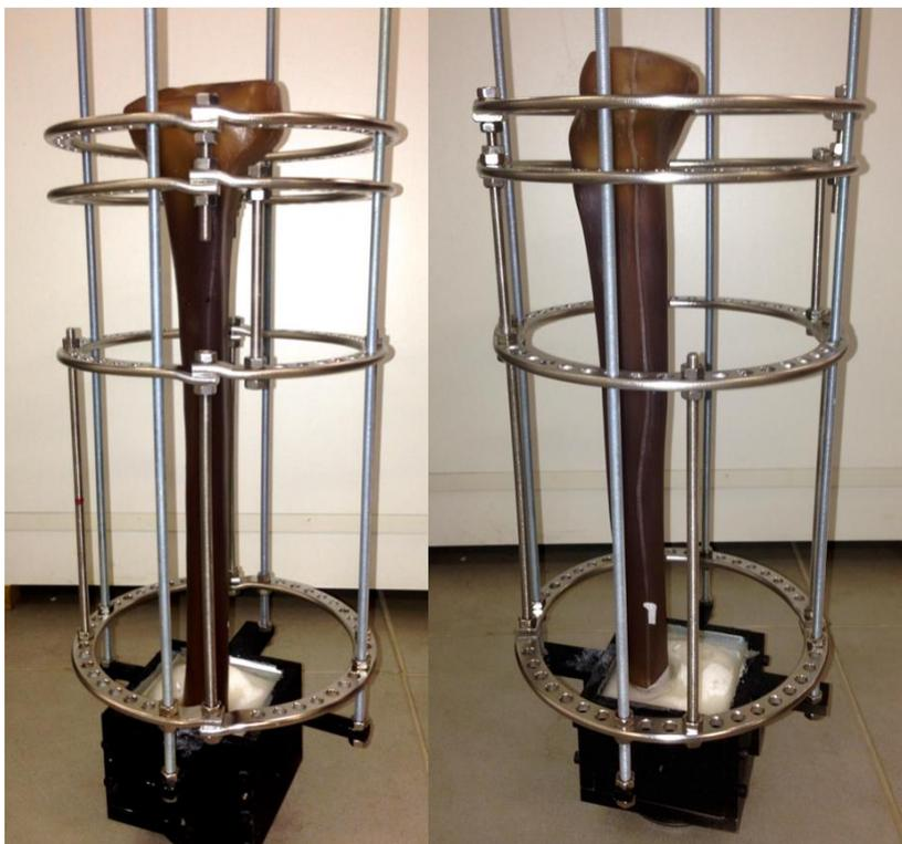
Figura 6: Posicionamento do aparelho em relação ao osso compósito por meio de hastes rosqueadas conectadas ao dispositivo de suporte metálico.
