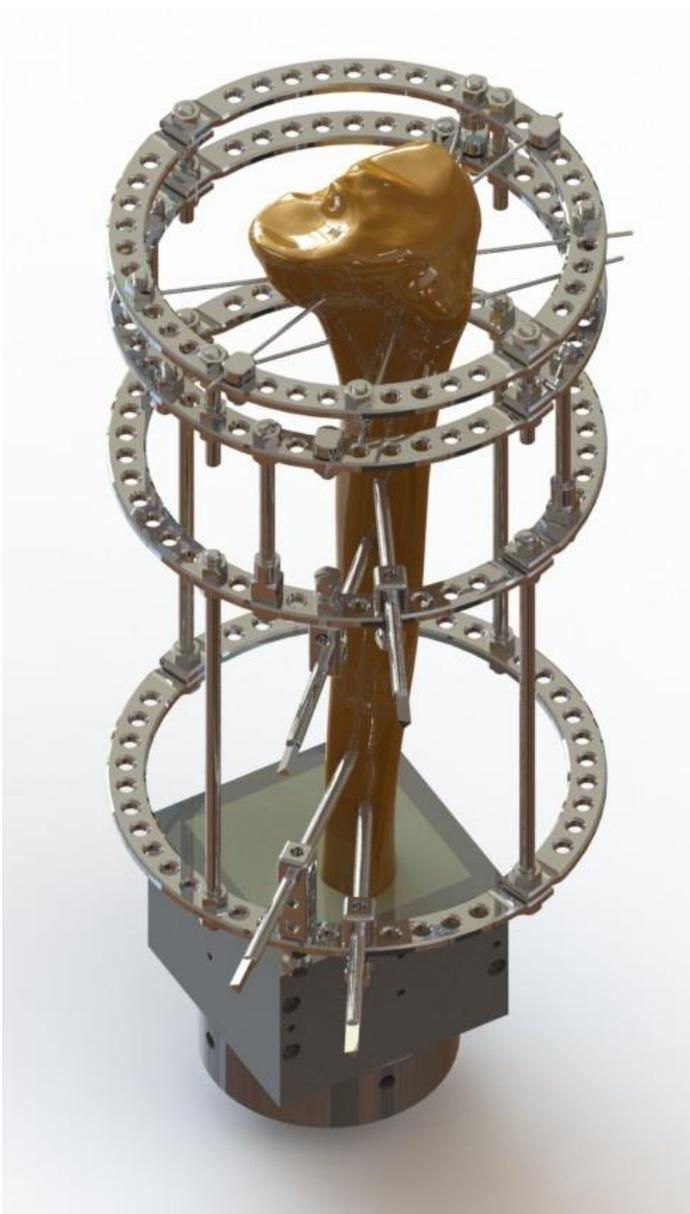
Figura 9: Ilustração do projeto da Montagem Teste demonstrando o posicionamento dos fios de Kirschner e dos pinos de Schanz utilizados.
