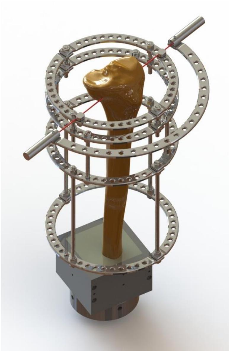
Figura 7: Ilustração do projeto do dispositivo para a padronização do posicionamento dos fios de Kirschner com utilização de *laser pointers* para a realização das montagens dos aparelhos de Ilizarov.
