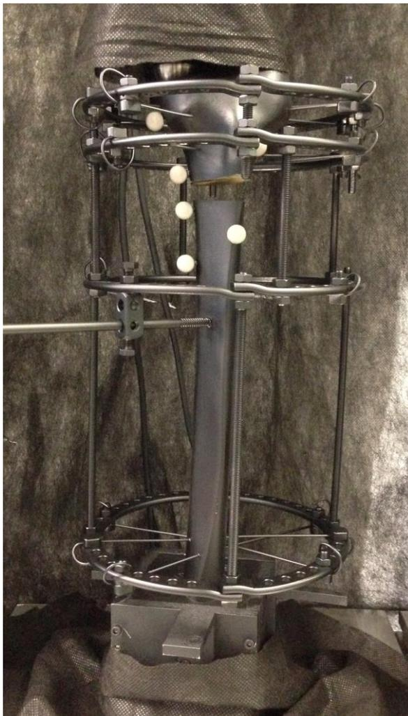
Figura 11: Fotografia do corpo de prova posicionado na máquina de testes para a realização do ensaio, evidenciando o posicionamento dos marcadores do OptiTrack®.
