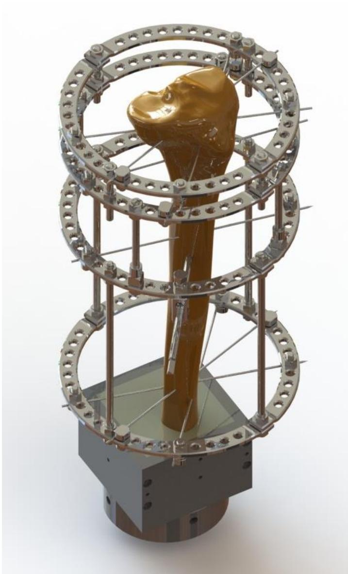
Figura 8: Ilustração do projeto da Montagem Padrão demonstrando o posicionamento dos fios de Kirschner e do pino de Schanz utilizados.
