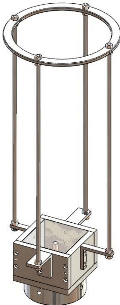
Figura 3: Ilustração do projeto do dispositivo metálico utilizado para a fixação das tíbias compósitas e para a padronização do posicionamento dos aparelhos circulares.
