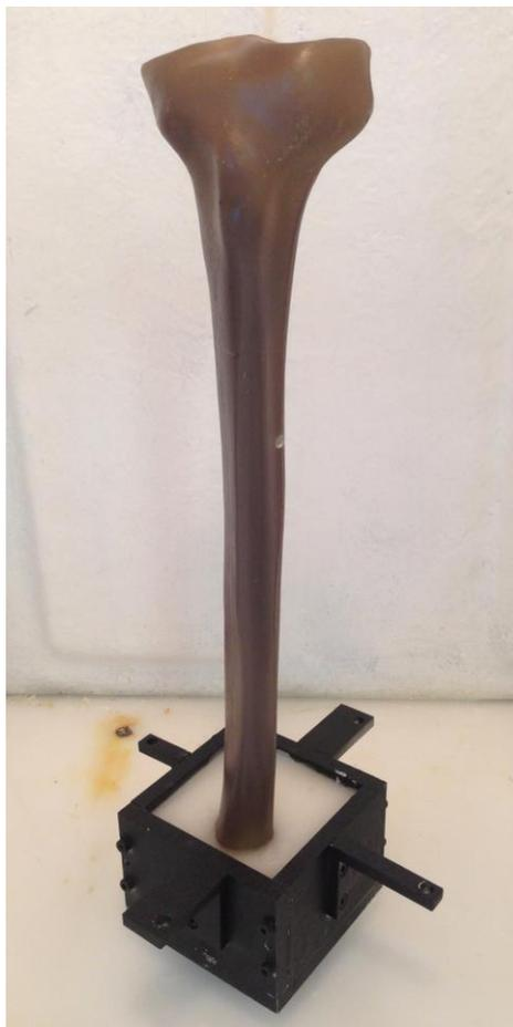
Figura 4: Fotografia ilustrando a fixação da tíbia compósita ao dispositivo metálico por meio de cimento ósseo.
