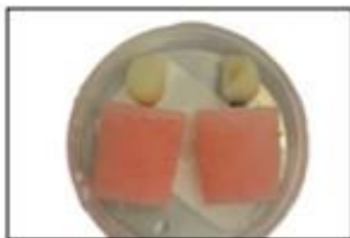
Fig.36. Armazenamento das restaurações em água destilada por 24hr antes do teste (A).
