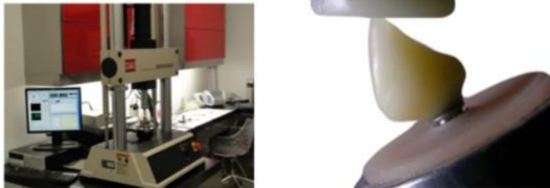
Fig.37: Máquina de fadiga utilizada (858 Mini Bionix II, MTS, Systems, EUA) (A). Espécime posicionado na célula de carga (B).
