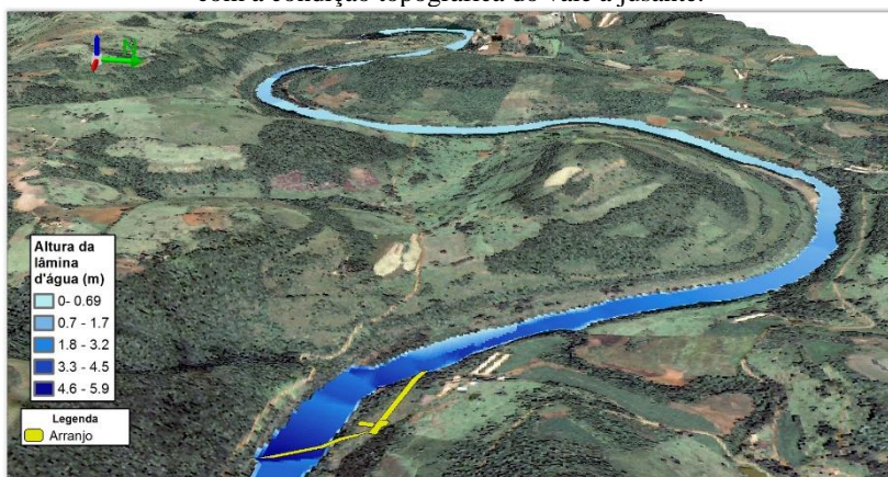
Figura 5.12 - Condição do rio do Peixe 5 minutos após a ruptura, juntamente com a condição topográfica do vale a jusante.
