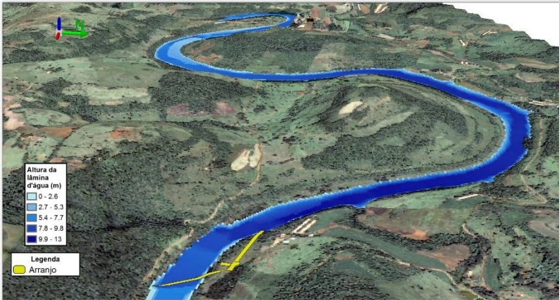
Figura 5.9 - Condição do rio do Peixe 5 minutos após a ruptura, juntamente com a condição topográfica do vale a jusante.
