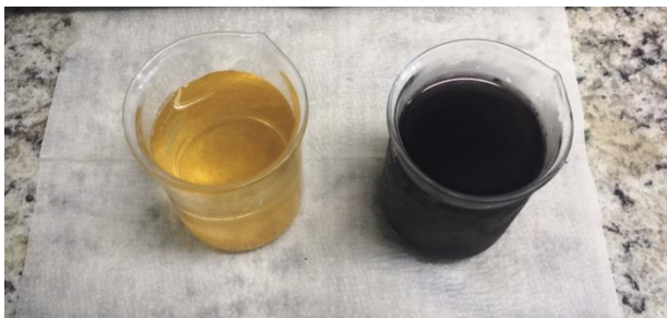
Figura 05 – Amostra de água do Rio Sangão (à esquerda) e amostra de efluente têxtil bruto (à direita)
