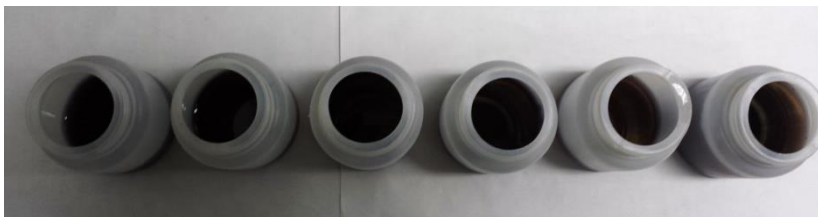
Figura 14: Amostras retiradas do reator 0, 5, 10, 15, 30 e 60 minutos (da esquerda para direita) após o início da reação de UV/H 2 O 2 , com concentração de 1000 mg/L (b) de H 2 O 2 .
