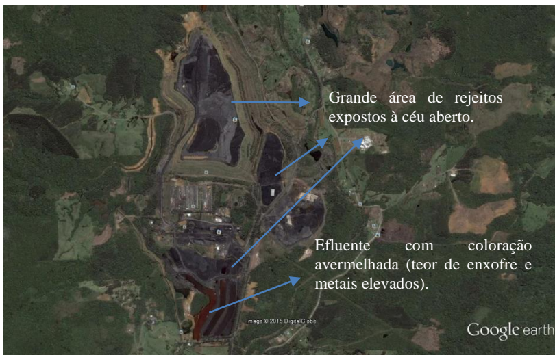
Figura 7: Área do empreendimento no ano de 2005. Fonte: Google Earth Pro®
