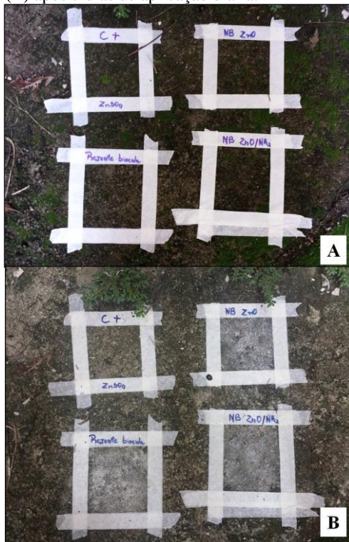
Figura 23 - Resultado obtido da aplicação das soluções de NB de ZnO e NB de ZnO@NH 2 na superfície externa (A) antes da aplicação e (B) após 7 dias de aplicação diária.
