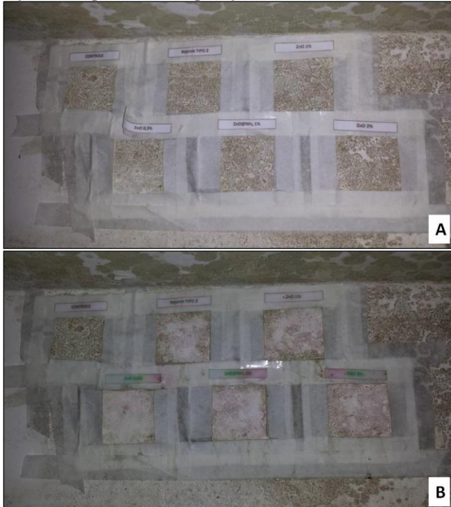
Figura 25 - Resultados obtidos da aplicação das soluções de NB de ZnO E NB de ZnO@NH 2 na superfície interna. (A) antes da aplicação e (B) após 7 dias de aplicação diária.
