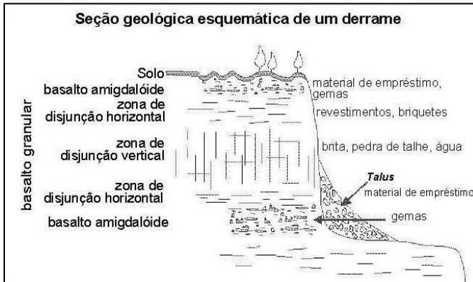
Figura 19 - Seção esquemática de um derrame basáltico. Fonte: CPRM, 2015.
