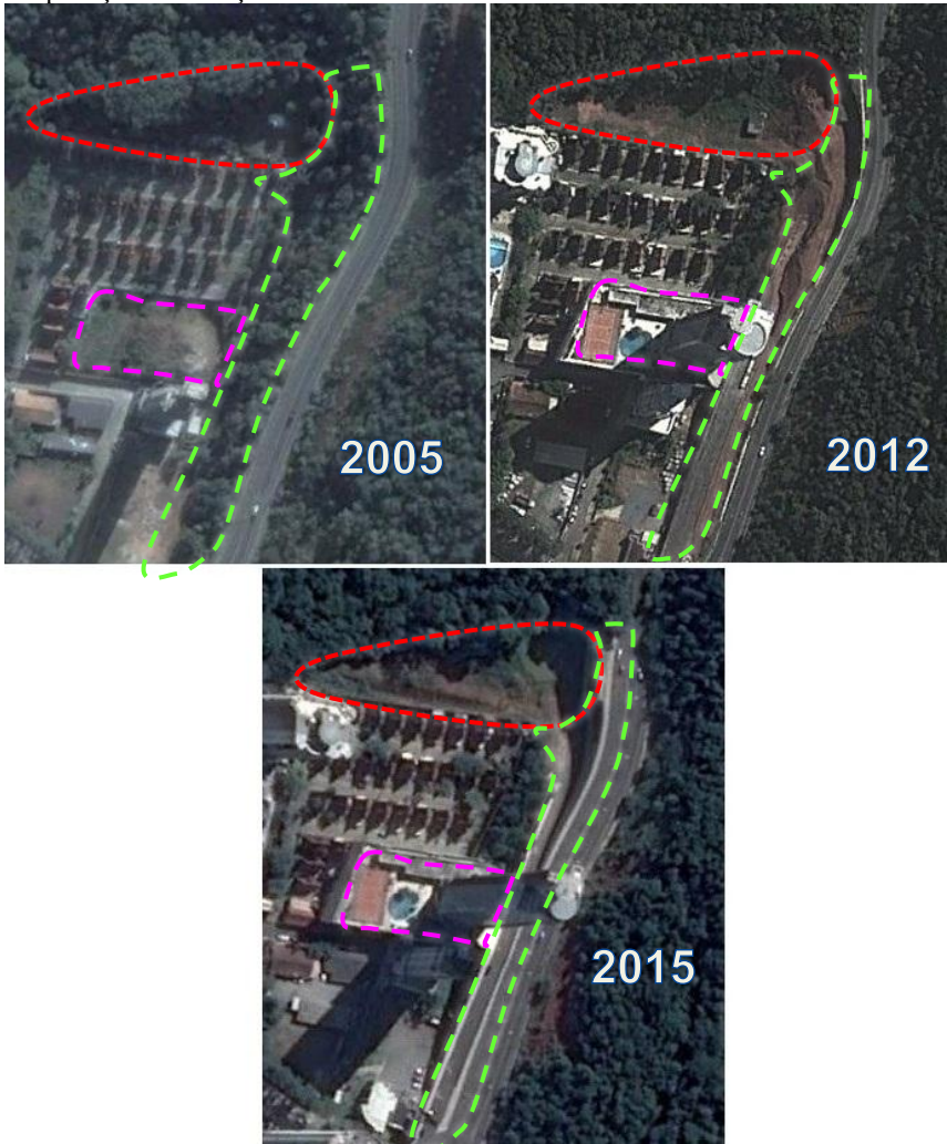
Figura 129 – Desmatamento e desbarrancamento acontecido entre 2005 e 2012, e “duplicação”/contenção feita em 2015.
