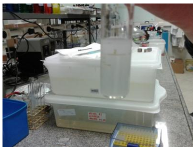
Figura 93. Aspecto da emulsão oleosa após a saturação do leito fixo.
