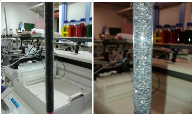
Figura 92. Aspecto da coluna de adsorção em leito fixo antes e após a saturação com óleo.
