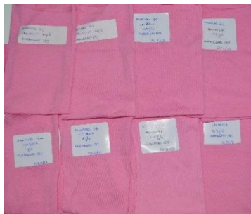
Figura 8 - Amostras tingidas com o corante Vermelho 195
