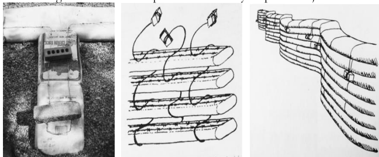
Figura 67 – Arame farpado e linhas de nylon presas a tijolos.
