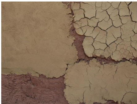
Figura 11 - Efeitos da estabilização granulométrica empírica em rebocos de terra sem aditivos.
