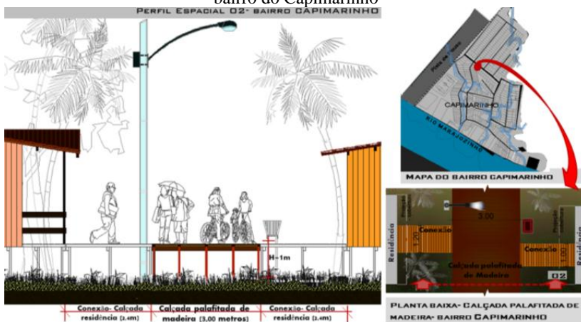
Figura 61- Perfil Espacial 02. Calçadas-ruas de madeira existente no bairro do Capimarinho
