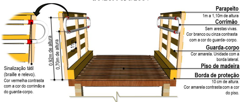
Figura 106- Guarda-corpo de madeira em conformidade com a NBR 14718/07 e a NBR 9050/2004
