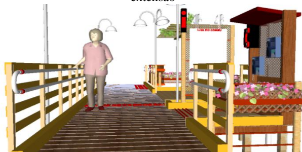
Figura 130- Calçada de estiva com guarda-corpo e corrimão em toda sua extensão
