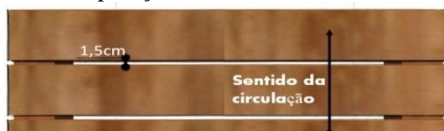
Figura 91- Separação máxima entre tábuas de 1,5 cm
