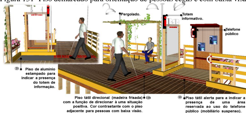
Figura 131- Piso demarcado para orientação de pessoas cegas e com baixa visão
