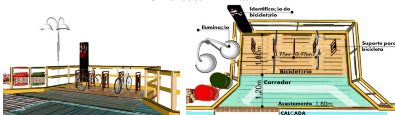
Figura 142- Exemplo de Bicletário para as calçadas de Afuá com as dimensões mínimas
