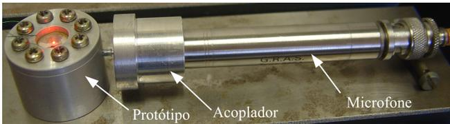
Figura 3.10 – Montagem do acoplador ao microfone e ao protótipo.
