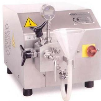
Ao término do cultivo (etapa 1 da Figura 2.1) realizaram-se três testes com variação de pressão de homogeneização e o número de passagens da suspensão celular pelo equipamento (etapa 2 da Figura 2.1): pressão 1300 bar e duas passagens (Ensaio 1); pressão 1300 bar e três passagens (Ensaio 2); pressão 1200 bar e três passagens (Ensaio 3).
