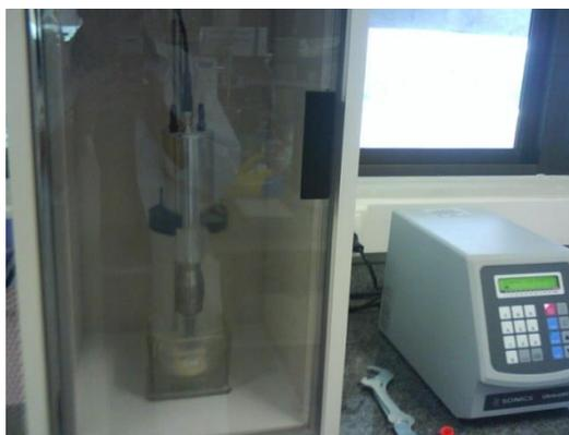
Ao término do cultivo (etapa 1 da Figura 2.1), a suspensão celular foi tratada com aplicação de ultrassom (etapa 2 da Figura 2.1). Para a ultrassonificação da suspensão celular, o volume de 35 mL desta foi disposto em um frasco de vidro de 50 mL, a fim de assegurar maior homogeneidade do sistema e a propagação das ondas em todo o volume de amostra, e colocada em contato com o bastão de aço inox.
