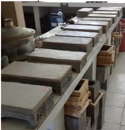
Figura 36: Análise visual do aparecimento de fissuras
