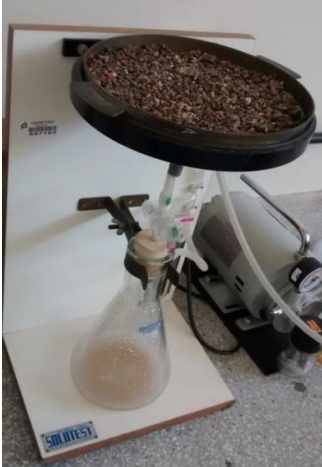
Figura 9- Sucção do excesso de água no agregado
