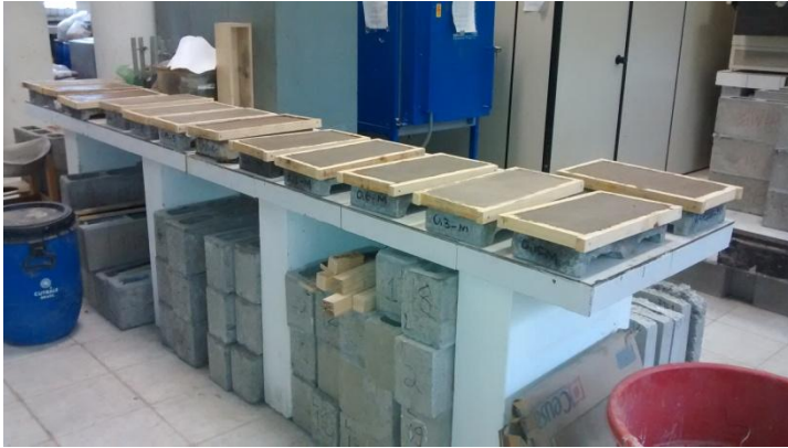
Figura 15- Moldagem das argamassas sobre substrato avaliação visual de fissuras
