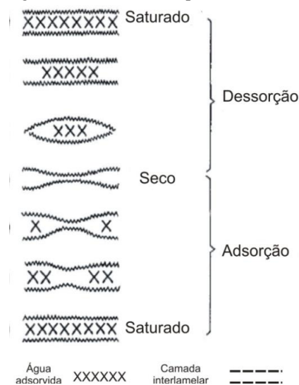
Figura 4- Mecanismo de pressão dissociada
