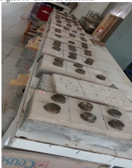
Figura 18- Ensaio de aderência
