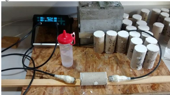
Figura 13- Ensaio de módulo de elasticidade dinâmico
