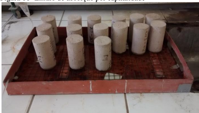
Figura 16- Ensaio de absorção por capilaridade
